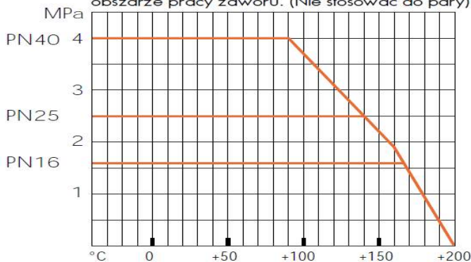
Wykres zależności (ciśnienie/temperatura) w obszarze pracy zaworu. (Nie stosować do pary).
